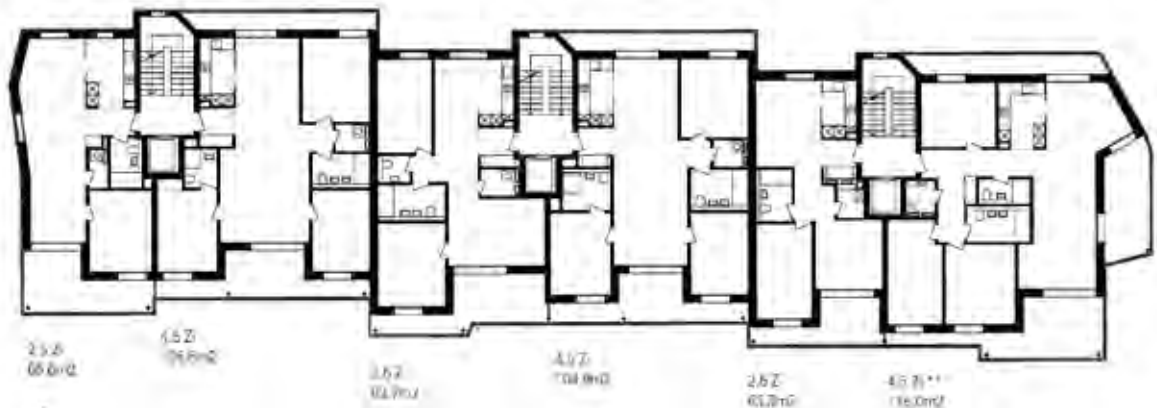
Grundriss Aufstockung 4. - 6. Obergeschoss
